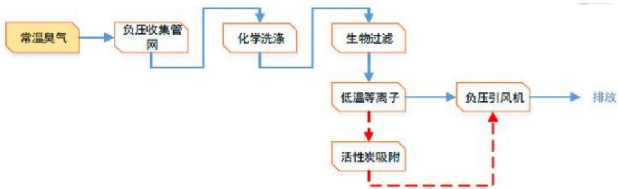
图 6-3 负压除臭（常温臭气）工艺流程图
