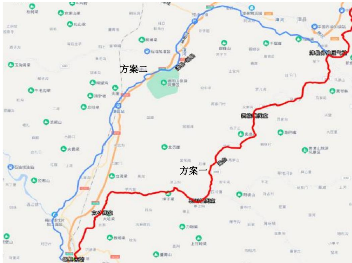
图 2-2 方案一和方案二管线走向示意图
