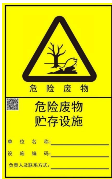
图 6.2.4-11 竖版危险废物贮存、利用、处置设施标志样式示意图
