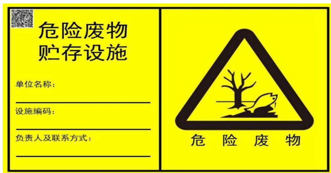
图 6.2.4-10 横版危险废物贮存设施标志样式示意图
