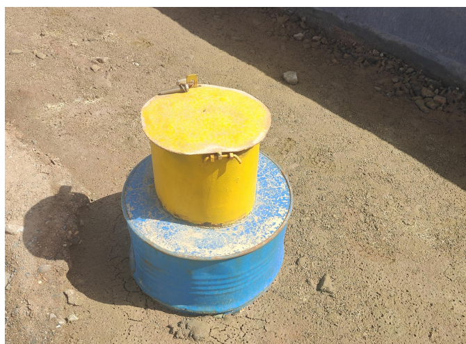
图 4.2-4 地下水监测井
