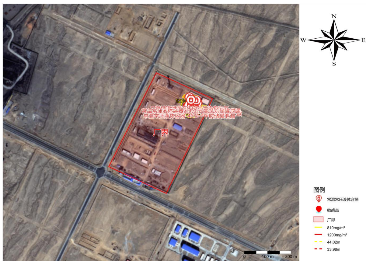
图 8.5.1-5 最不利气象条件下 1，2-二氯乙烷储罐泄漏环境影响范围
